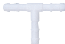
型号: JTCX10 T 型软管三端接头用于软管 \varnothing 5 \times 8 mm 包装: 10 组 / 包
