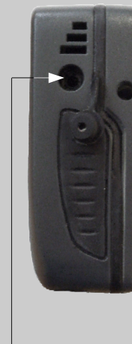
Jack 连接端口 (3.5) 用于记录仪和电脑软件连线使用
